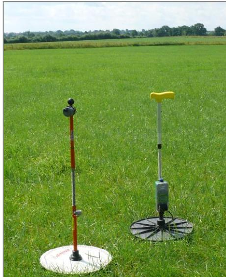
**Abbildung 2:** Rising-Platemeter zur Bestandshöhenmessung in unterschiedlichen Ausführungen (links die im Projekt verwendete Ausführung „Filips Manual Folding Platemeter“).
